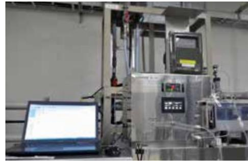
ピコプランクトンカウンタによる浄水処理工程での連続測定
